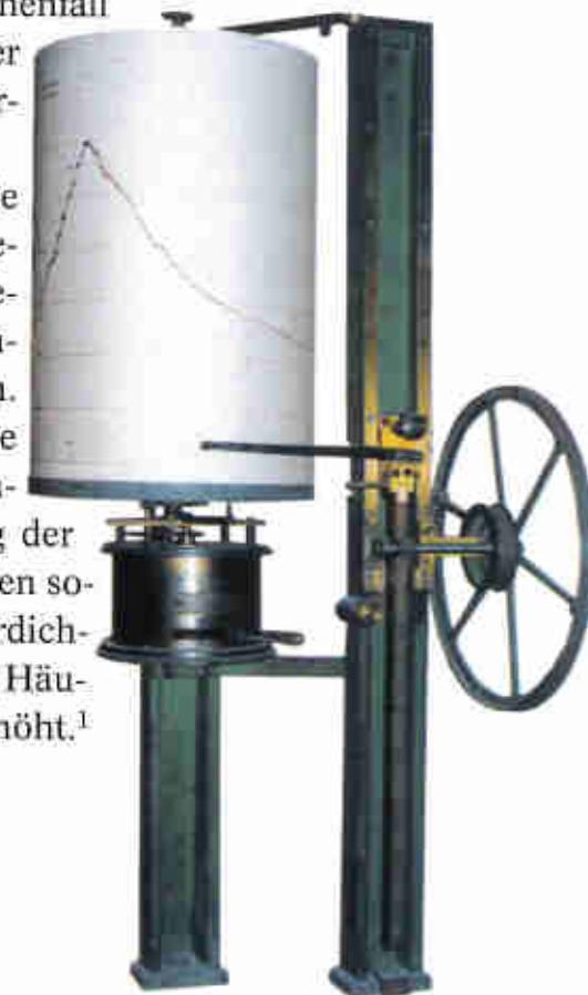
Ein Schreibpegel wie dieser der Firma Ganser ist auch in Engelhartzell im Einsatz Sammlung Hydrographischer Dienst
