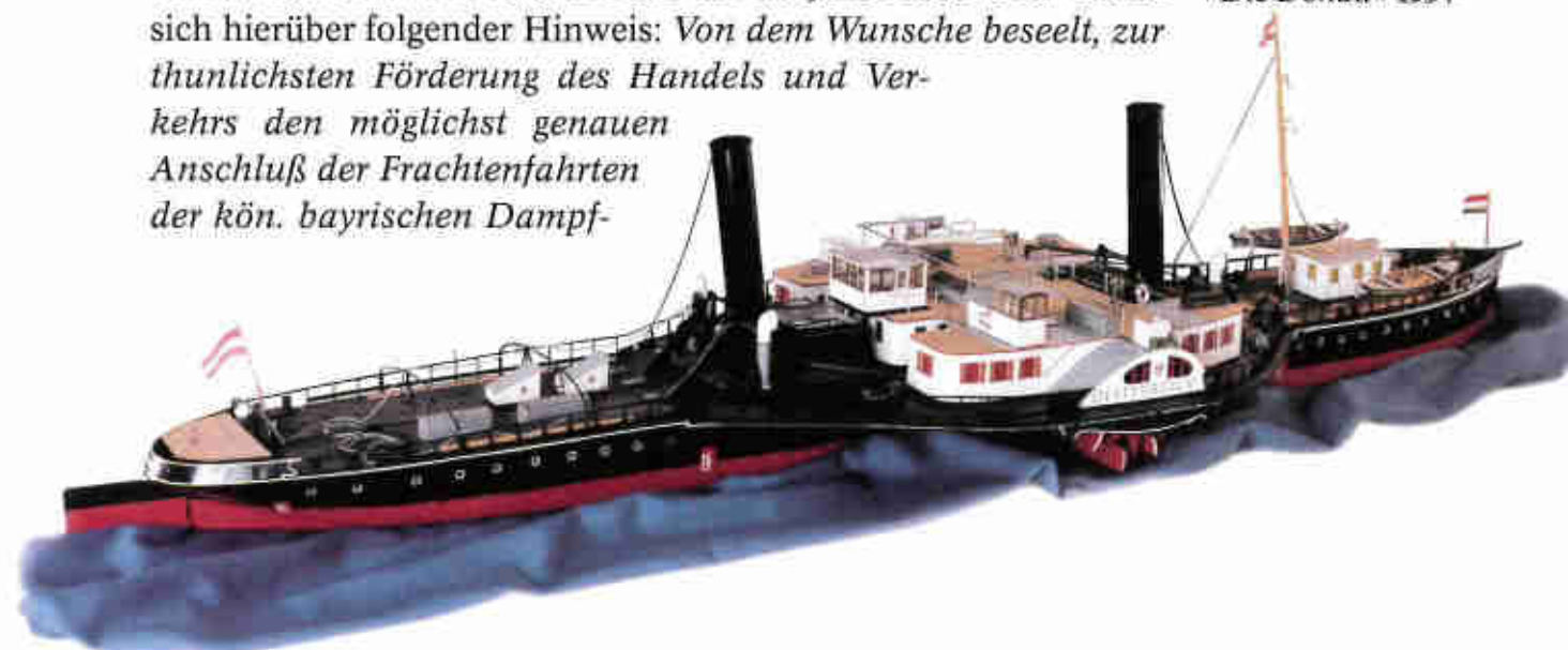
Dampfzugschiff (DZS) »Österreich« 2400 PS, erbaut 1927, ab 1937 »Ostmark«, später »Stalingrad« bzw. »Wolgograd« Modell auf der Öö. Landesausstellung »Die Donau« 1994
